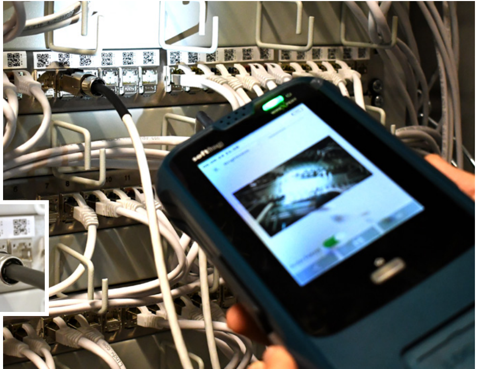
Vor der Prüfung - Scannen des Etiketts mit dem WireXpert MP
