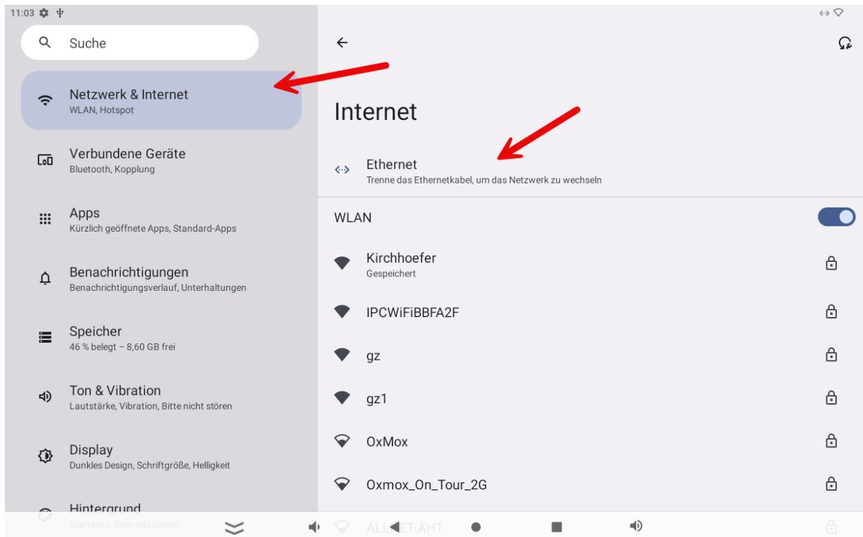
Ethernet wird automatisch aktiviert sobald ein Netzwerkkabel mit einer Netzwerkverbindung angeschlossen wird. Die Ethernet Verbindung wird vor einer WLAN Verbindung bevorzugt.
