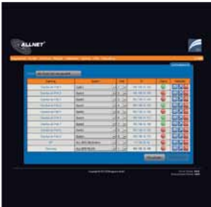
◀ Bild1: Übersicht über alle verwalteten Geräte mit der Möglichkeit diese ein- und auszuschalten
