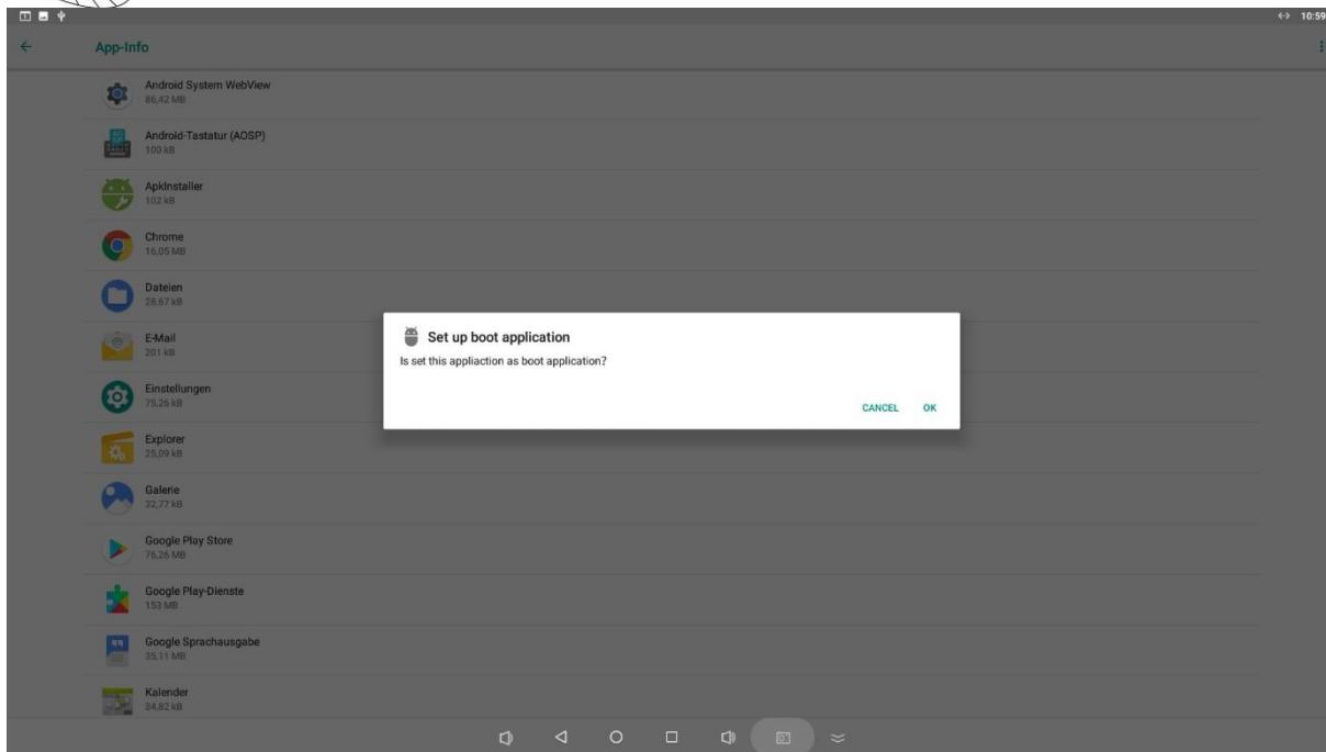
Mit Ok bestätigen. Beim Neustart, startet die Anwendung automatisch.
