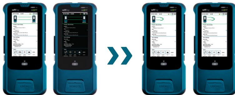
Einstellung für die Loop-Prüfung von LWL-Verkabelungen
