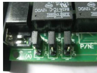
Abbildung 4: Jumperstellung Schließer (AC)
