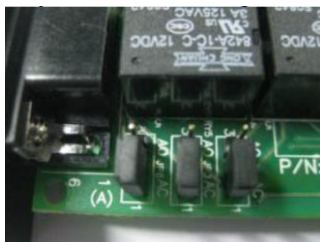
Abbildung 3: Jumperstellung Öffner (AO)
