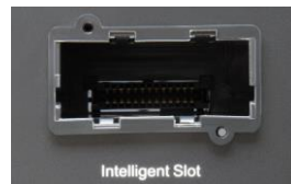
Abb. 3-17 Adapter-Einschub zur Aufnahme einer Relais-Karte oder eines SNMP-Adapters (links geschlossen, rechts geöffnet).
