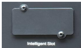
Abb. 3-17 Adapter-Einschub zur Aufnahme einer Relais-Karte oder eines SNMP-Adapters (links geschlossen, rechts geöffnet).
