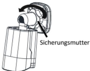
Montieren Sie die Kamera an der Wand und schließen Sie alle Kabel an.
