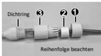
Befestigen Sie den Dichtring am Ethernet-Anschluss. Montieren Sie die wasserdichten Komponenten der Reihe nach. Stecken Sie dann das Kabel in den Ethernet-Anschluss und schrauben Sie die wasserdichte Schraube ein.
