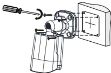
Führen Sie die selbstschneidenden Schrauben durch die Löcher im Sockel und ziehen Sie sie mit einem Schraubendreher an der Wand fest.
